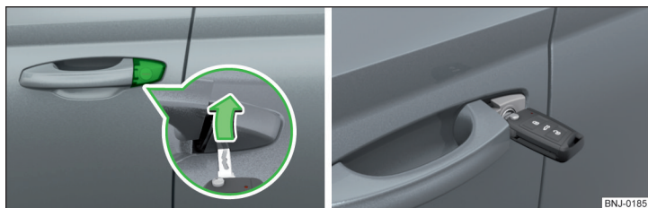
Фиг. 193 Дръжка на вратата на шофьора: отваряне на капачката на ключалката / ключалка с ключ
