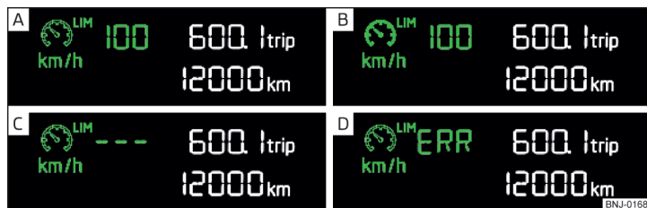
Фиг. 138 Сегментен дисплей: Примери за показания на състоянието на ограничителя на скоростта
