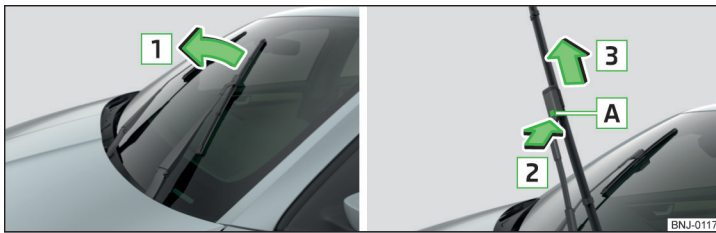
Фиг. 198 Смяна на перото на стъклочистачка на предното стъкло
