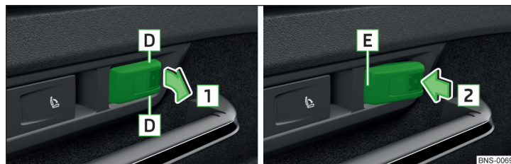
Фиг. 138 Подвижно осветително тяло: изваждане/поставяне
