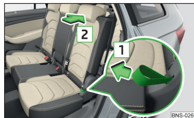
Фиг. 75 Настройка на облегалката на седалката
