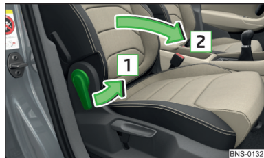
Фиг. 72 Сгъване напред на облегалката на пътника до шофьора
