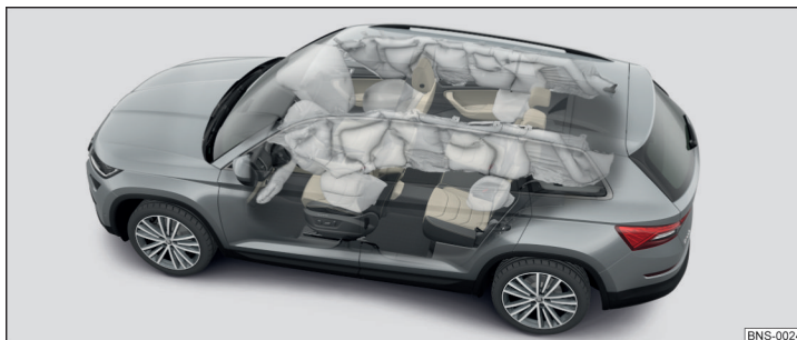
Фиг. 10 Еърбези, напълнени с газ
