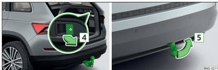
Фиг. 320 Щанга със сферична глава: вкарване
