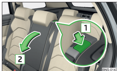
Фиг. 78 Сгъване напред на средната облегалка на седалката
