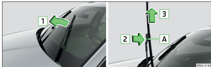
Фиг. 365 Смяна на перото на стъклочишачка на предното стъкло
