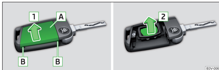
Фиг. 354 Снемане на капачката / изваждане на батерията
