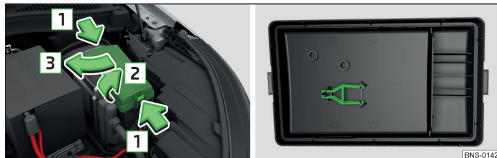
Фиг. 371 Сваляне на капака на кутията с предпазители / пластмасова щипка за предпазители
