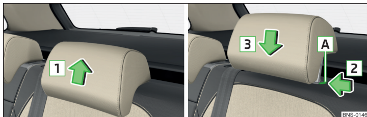
Фиг. 83 Настройка на височината на опорите за главата на втория ред седалки
