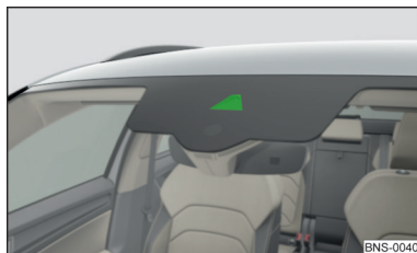
Фиг. 316 Сензор за разпознаване на пътни знаци
