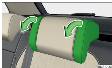
Фиг. 84 Сгъване напред на страничните елементи на опорите за главата
