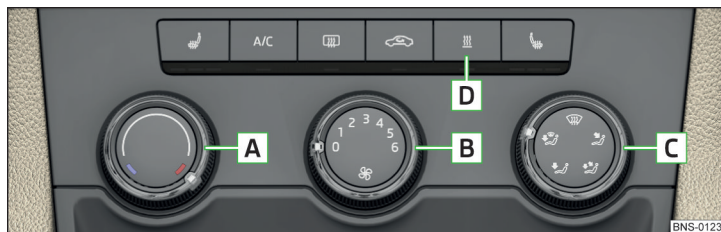
Фиг. 145 Контролни елементи на отоплението/климатика
