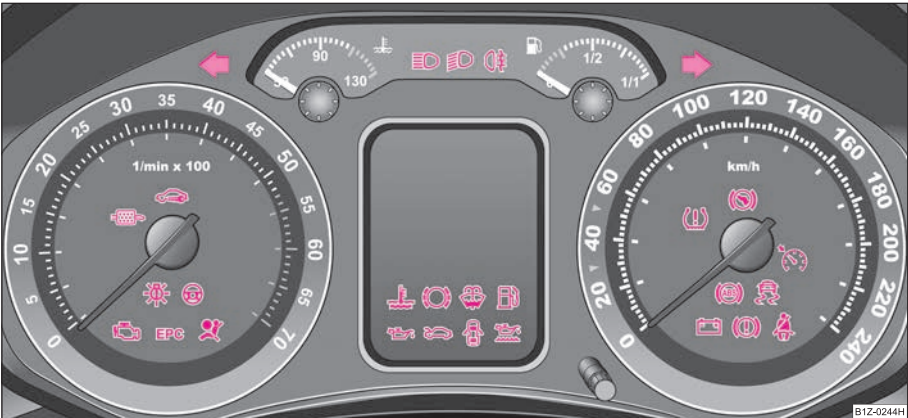
Изобр. 19 Арматурно табло с контролни светлини
