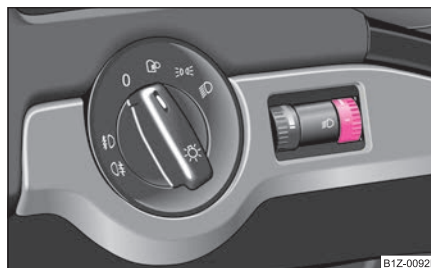
Изобр. 43 Арматурно табло: нагласяване на наклона на фаровете
