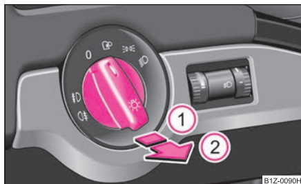
Изобр. 39 Арматурно табло: превключвател на светлините
