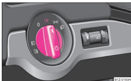
Изобр. 40 Арматурно табло: превключвател на светлините
