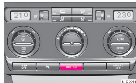
Изобр. 186 Превключвател за нагласяване на контролното значение на налягане в гумите.
