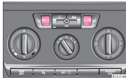
Изобр. 70 Арматурно табло: въртящ се регулатор за отопление на предните седалки.
