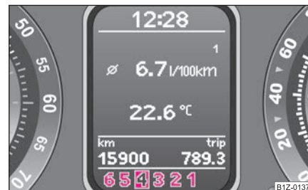
Изобр. 147 Голям информационен дисплей: ръчно превключване на скорости
