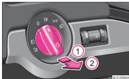
Изобр. 41 Арматурно табло: превключвател на светлините
