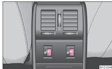
Изобр. 71 Средна конзола отзад: въртящ се регулатор за отопление на задните седалки.
