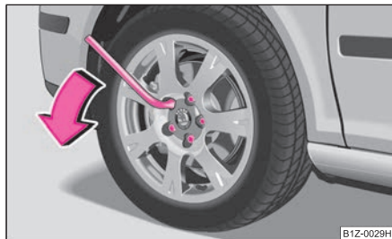
Изобр. 214 Смяна на колело: разхлабване на винтове
