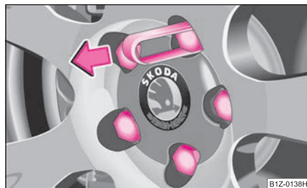
Изобр. 212 Смякване на капаче за винт на колело
