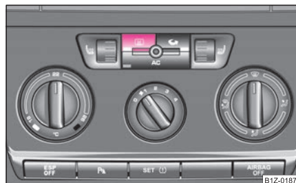
Изобр. 49 Превключвател за нагриване на задното стъкло
