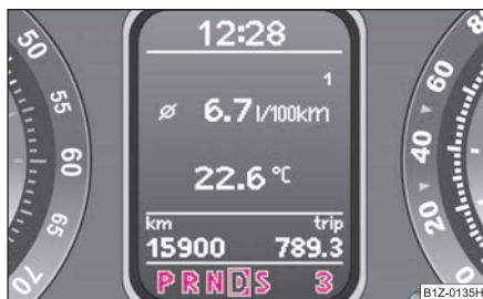
Изобр. 140 Информационен дисплей: позиции на скоростен лост
