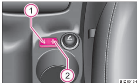
Изобр. 27 Средна конзола: превключвател на централно заключване
