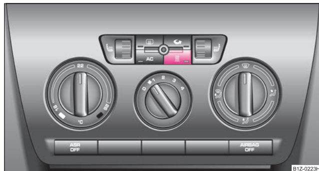
Изобр. 129 Бутона за прякото включване (изключване) на независимото допълнително отопление и вентилация на панела за управление на климатик
