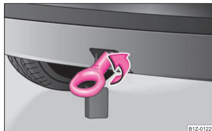
Изобр. 221 Задна броня: монтаж на халка за теглене
