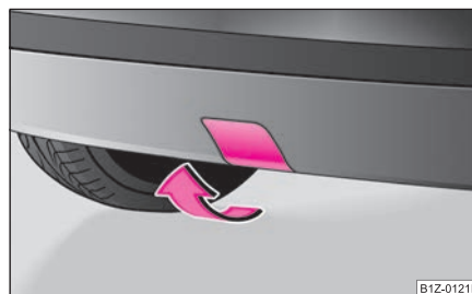
Изобр. 220 Задна броня: демониране на капак
