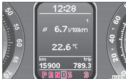
Изобр. 145 Информационен дисплей: позиции на скоростен лост
