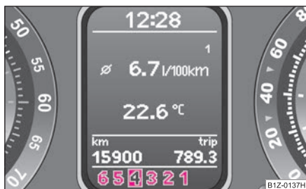
Изобр. 142 Голям информационен дисплей: ръчно превключване на скорости
